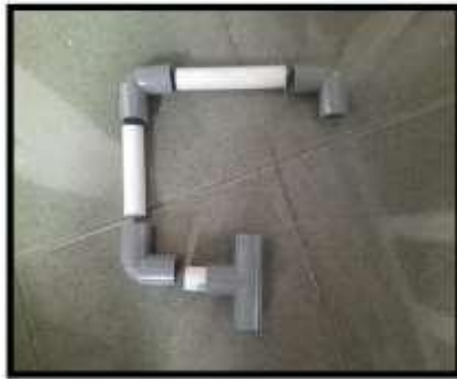
Gambar 4 Handle Dari Pipa PVC
