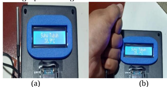
Gambar 8. Pengujian Keakuratan Suhu Tubuh (°C) Pada Sensor DS18B20 (a) Sensor Belum Digenggam (b) Sensor Digenggam
