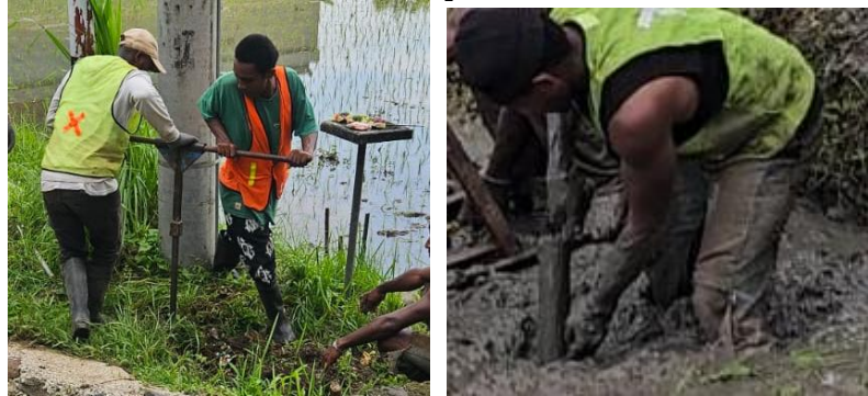
Gambar 12. Proses Sondir dan Pengangkatan Tabung Sampel Tanah
