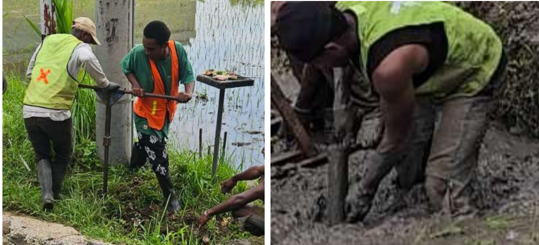
Gambar 12. Proses Sondir dan Pengangkatan Tabung Sampel Tanah
