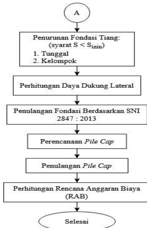
Gambar 2 Tahapan Perencanaan Fondasi Tiang Bor (Lanjutan)
