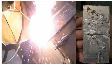
**Gambar 2** Proses Pengelasan Material AL-5052 dan Hasil dari proses pengelasan
