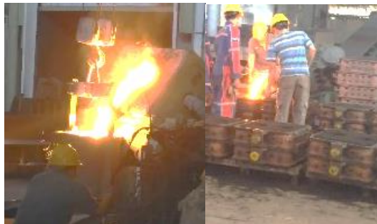
Gambar 9. Proses tapping dan pouring
