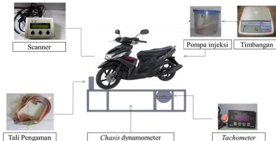
Gambar 6. Setup pengujian
