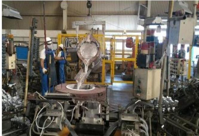
**Gambar 4. Proses penuangan ke dalam Tanur Induksi**
