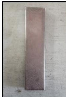
Gambar 3.2 Plat Baja Karbon ASTM A36 Sedangkan sifat mekanis dari material yang digunakan dalam pengujian ini adalah sebagai berikut.
