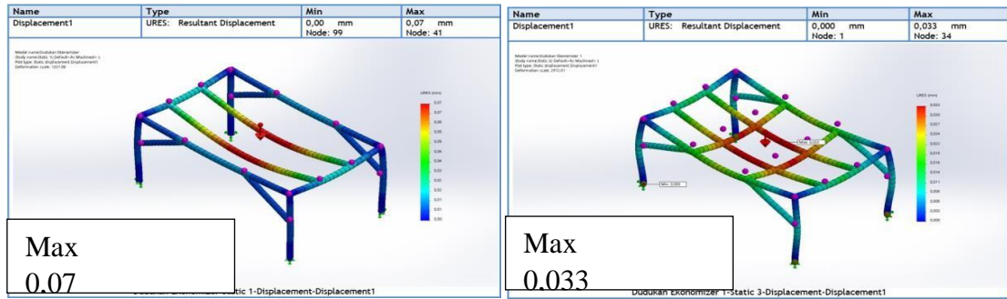
Gambar 12. Displacement pada Desain Rangka (Kiri) 1 dan Displacement pada Desain Rangka 2 (Kanan)
