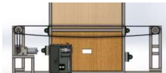
Gambar 4. Skema kerja sistem mekanik alat deteksi cacat kain
