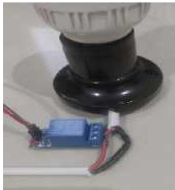
Gambar 3.16 pemasangan kabel ke relay
