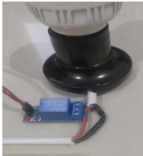
Gambar 3.16 pemasangan kabel ke relay
