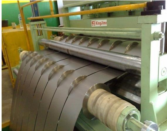
Gambar 4. Proses Pemotongan Coil
