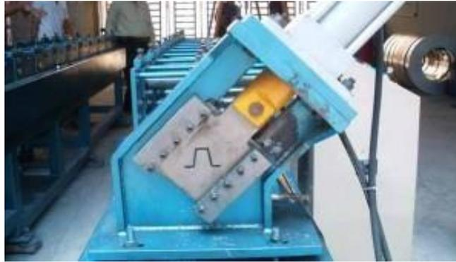
Gambar 11. Proses Pemotongan Reng
