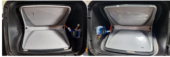
Gambar 4 Pemasangan Motor Servo
