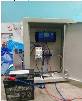
Gambar 5. Pengujian Pengisian Akumulator
